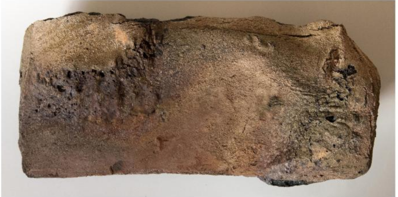
Mattone storto deformatosi al contatto con l'atmosfera
