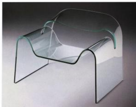
Cini Boeri, poltrona Ghost, 1987, Fiam La poltrona prende forma a partire da un'unica lastra di vetro dello spessore di 12 millimetri, prima incisa da un getto d'acqua ad alta pressione e alta velocità (1000 metri al secondo) cui si viene ricorrendo ad un unico taglio precisissimo e poi formata a caldo.
