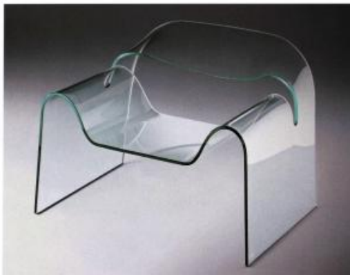
Cini Boeri, poltrona Ghost, 1987, Fiam La poltrona prende forma a partire da un'unica lastra di vetro dallo spessore di 12 millimetri, prima incisa da un getto d'acqua ad alta pressione e alta velocità (1000 metri al secondo) con cui viene ricavato un unico taglio precisissimo e poi formata a caldo.
