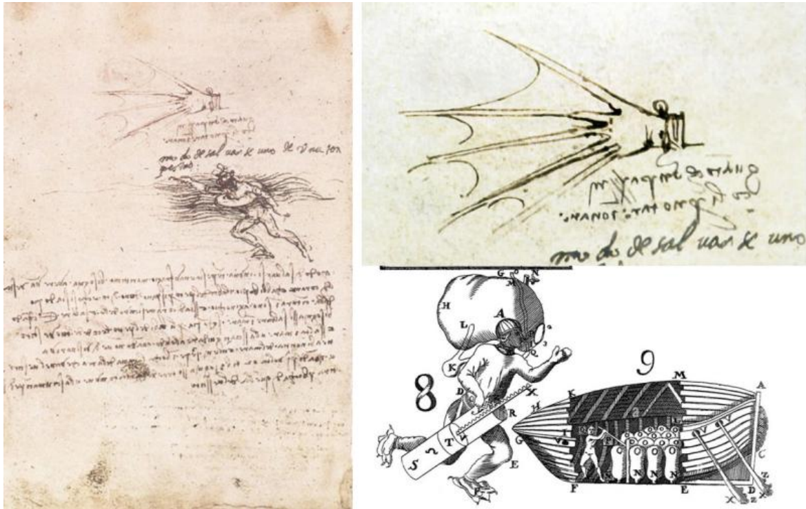
Leonardo da Vinci, Ms B (Parigi, Institut de France) disegno di guanto pinnato, pagina d'insieme e dettaglio. Giovanni Alfonso Borelli, De motu animalium , tavola XIV con apparecchio di immersione individuale, 28 gennaio 1608 - 31 dicembre 1679.
